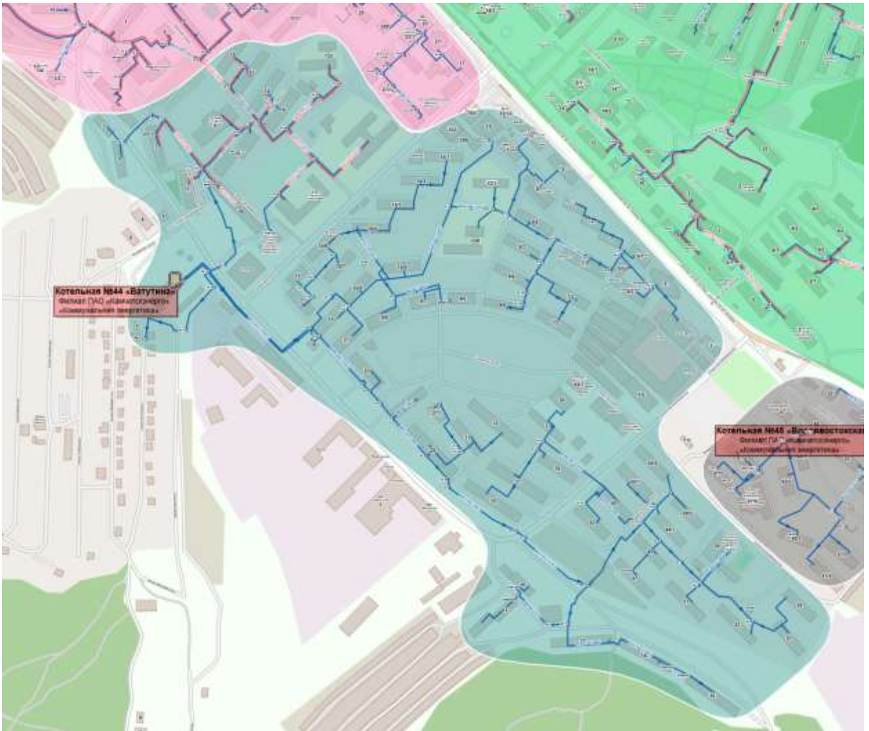
Рисунок 4.1.22 – Зона действия котельной №44 «Ватутина»
