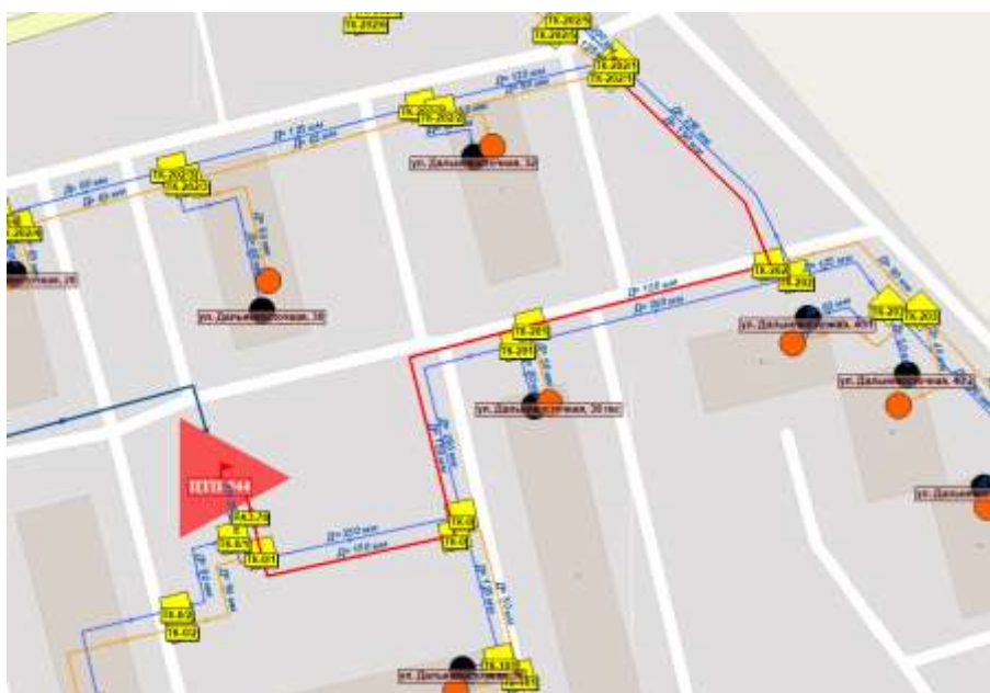
Рисунок 6.2 – Предлагаемая трассировка тепловых сетей от ЦТП-344 до ТК-202/1
