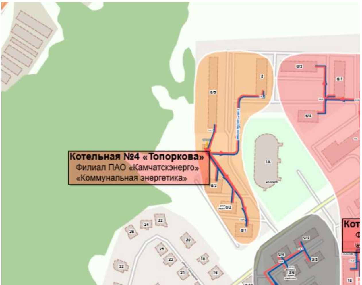
Рисунок 4.1.6 – Зона действия Котельной №4 «Топоркова»
