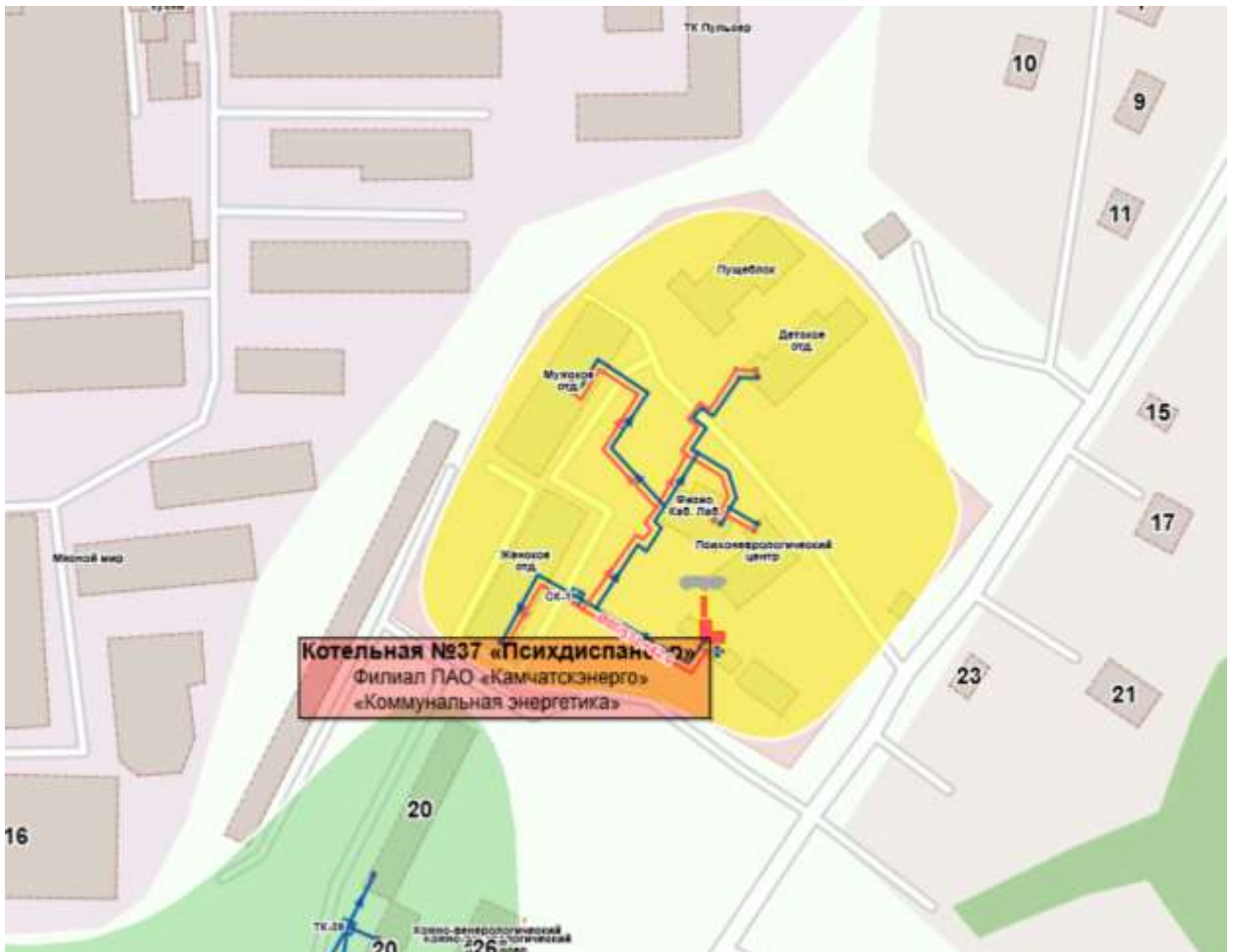
Рисунок 4.1.18 – Зона действия котельной №37 «Психдиспансер»
