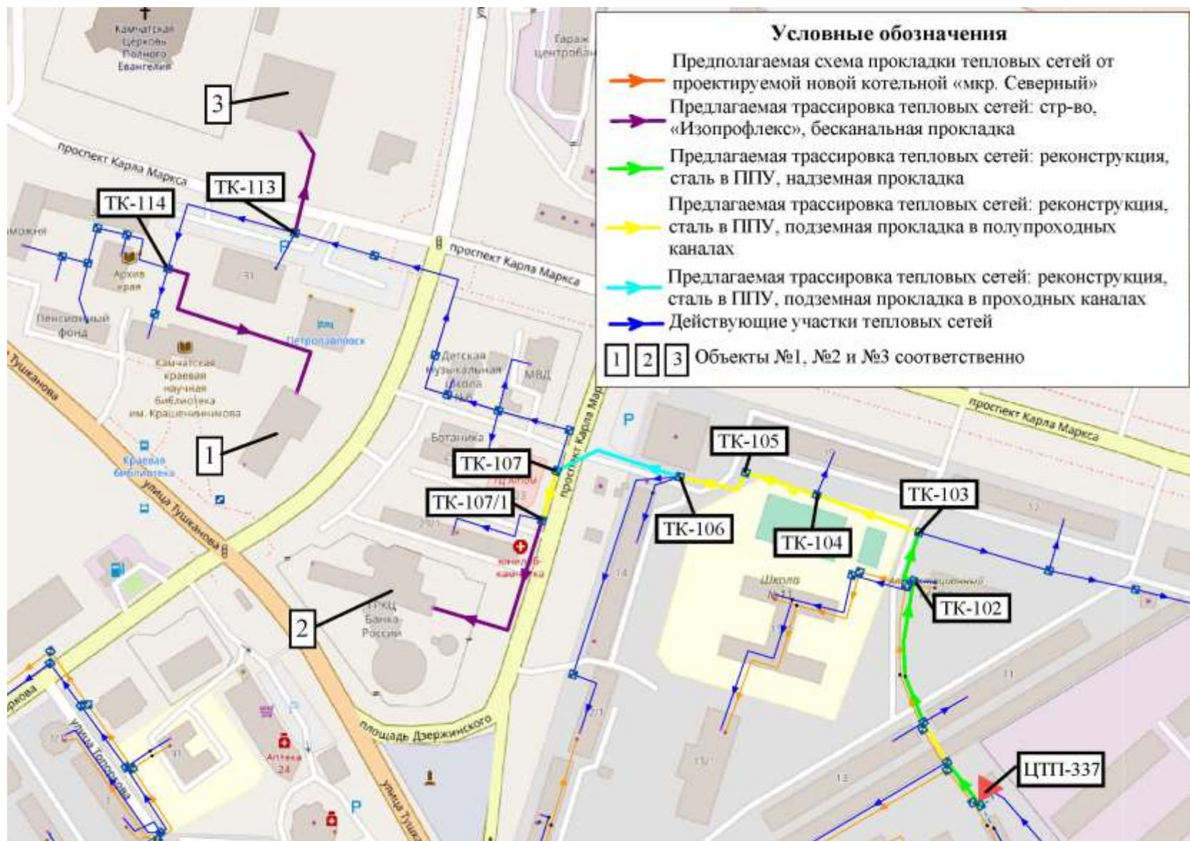
Рисунок 2.2 – Схема расположения существующих и планируемых элементов систем теплоснабжения по варианту № 2
