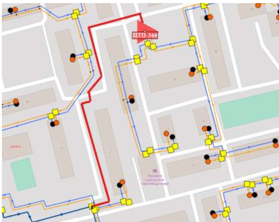
Рисунок 5.1 – Планируемая трассировка тепловых сетей от ТК-13/1 к ЦТП-344
