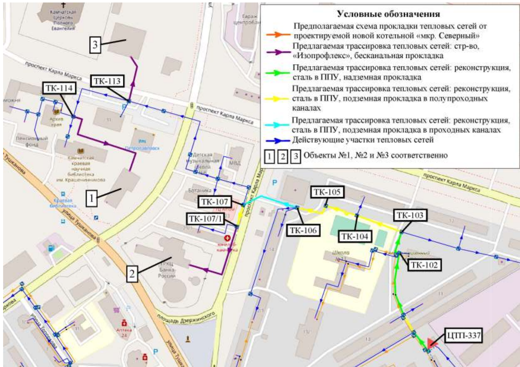
Рисунок 1.17 – Схема расположения существующих и планируемых элементов систем теплоснабжения по варианту № 2
