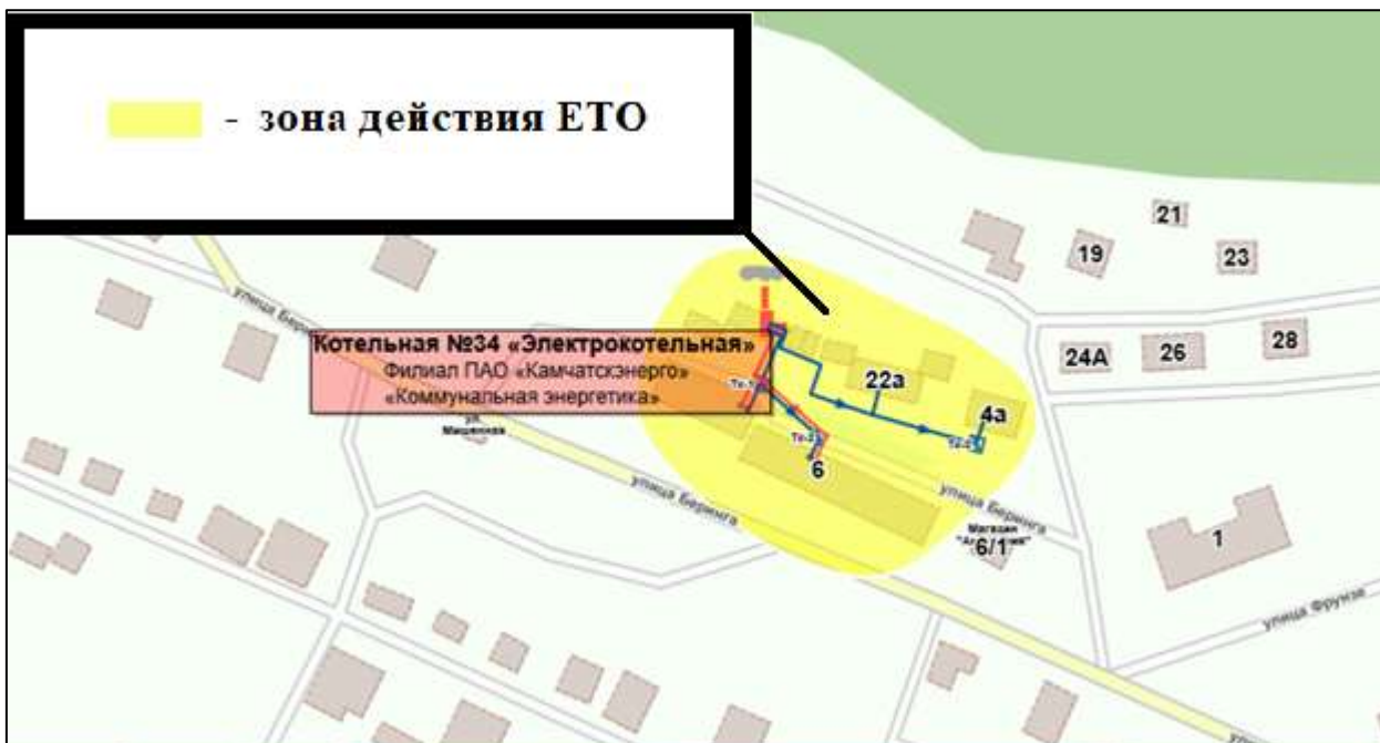
Рисунок 5.17 – Зона деятельности ЕТО № 01 (ПАО «Камчатскэнерго») в границах зоны действия системы теплоснабжения № 17 (ИТЭ: Котельная №34 «Электрокотельная»)
