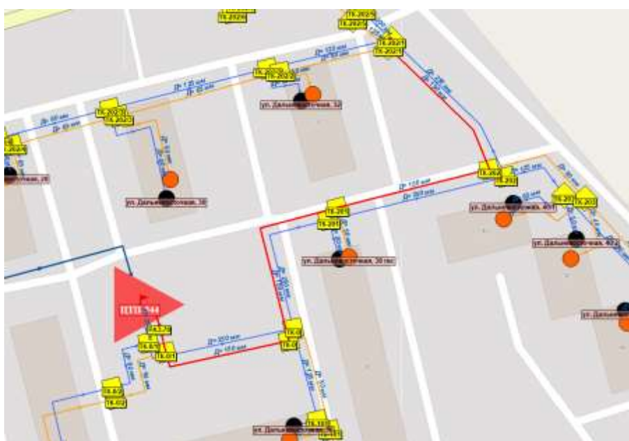
Рисунок 5.2 – Предлагаемая трассировка тепловых сетей от ЦТП-344 до ТК-202/1
