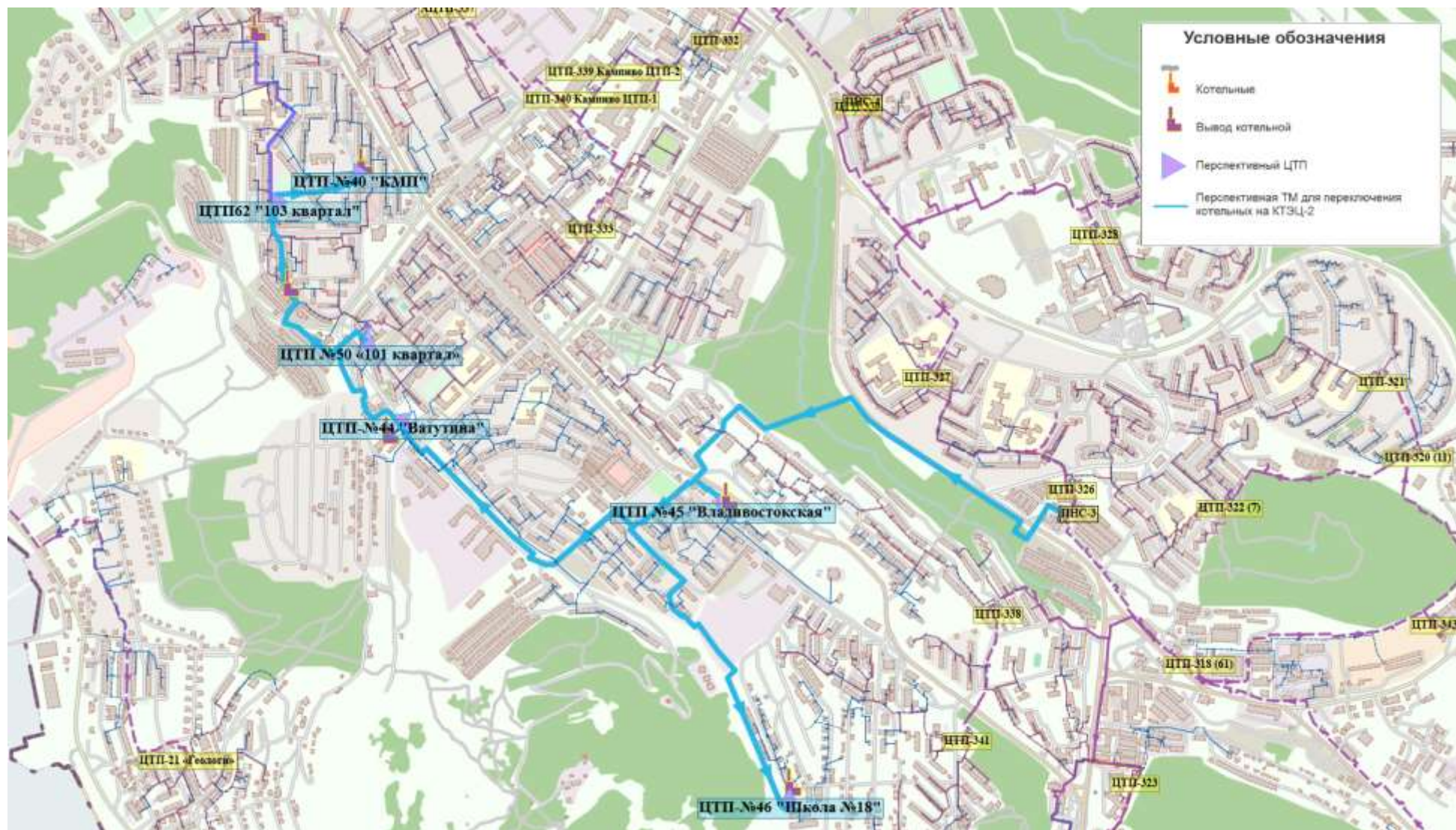
Рисунок 1.4 – Предлагаемая трассировка тепловых сетей для переключения котельных на КТЭЦ-2
