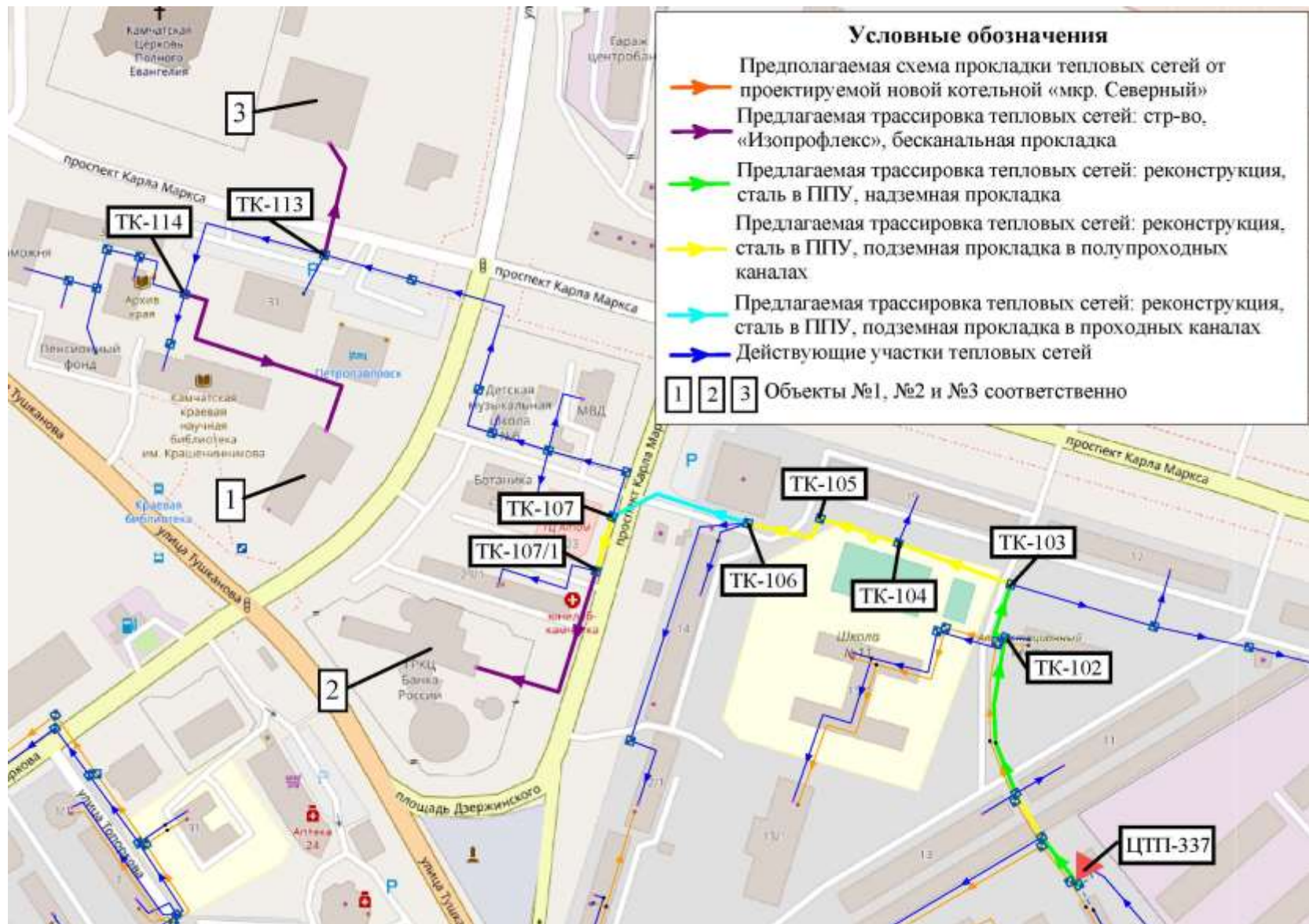
Рисунок 4.17 – Схема расположения существующих и планируемых элементов систем теплоснабжения по варианту № 2
