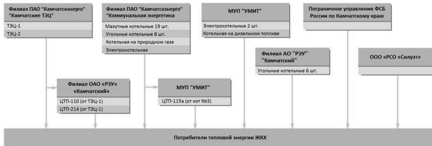
Рисунок 1.1 – Функциональная структура системы теплоснабжения Петропавловск-Камчатского городского округа
