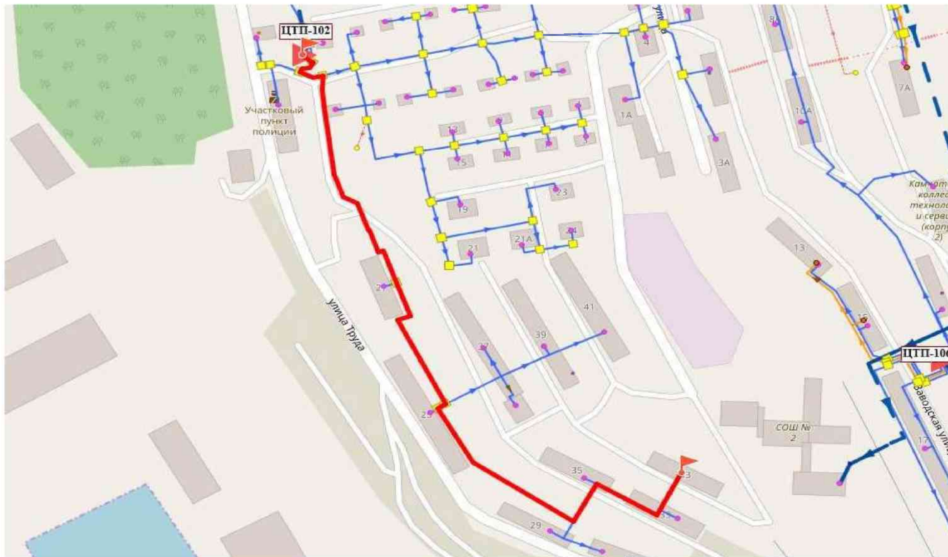
Рисунок 1.1.31. Путь пьезометрического графика от ЦТП 102
