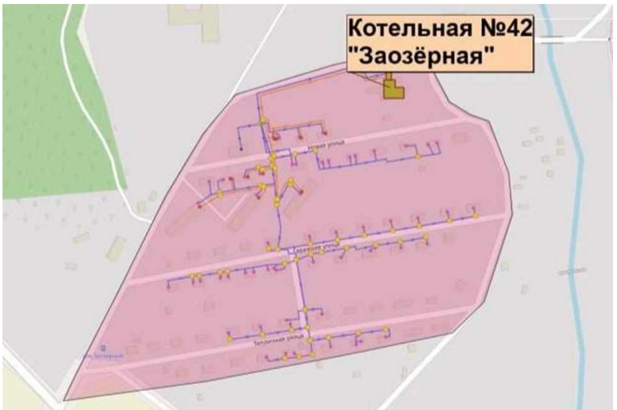
Рисунок 4.1.1-21 Зона действия котельной №42 «Заозёрная»
