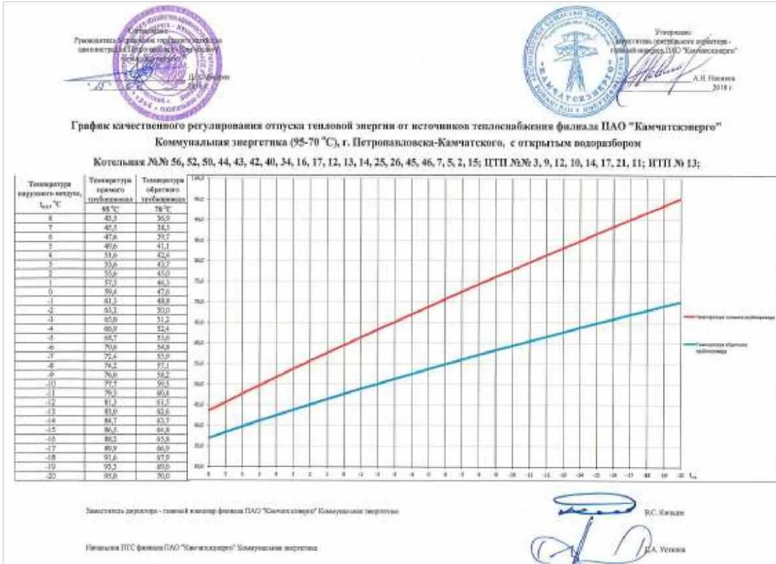
Рисунок 5.8.9 График качественного регулирования отпуска тепловой энергии
