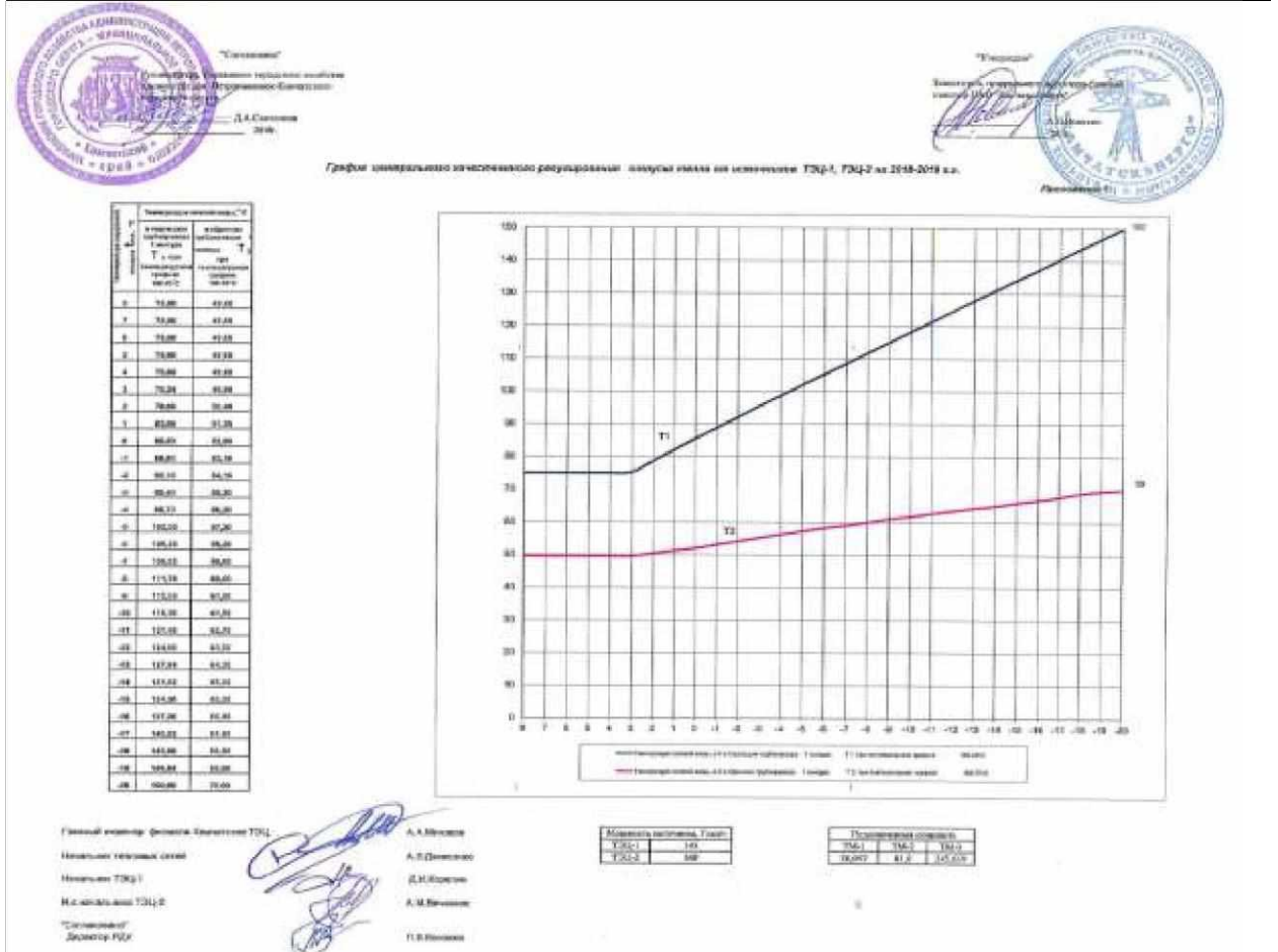
Рисунок 5.8.1 График центрального качественного регулирования от КТЭЦ-1, КТЭЦ-2
