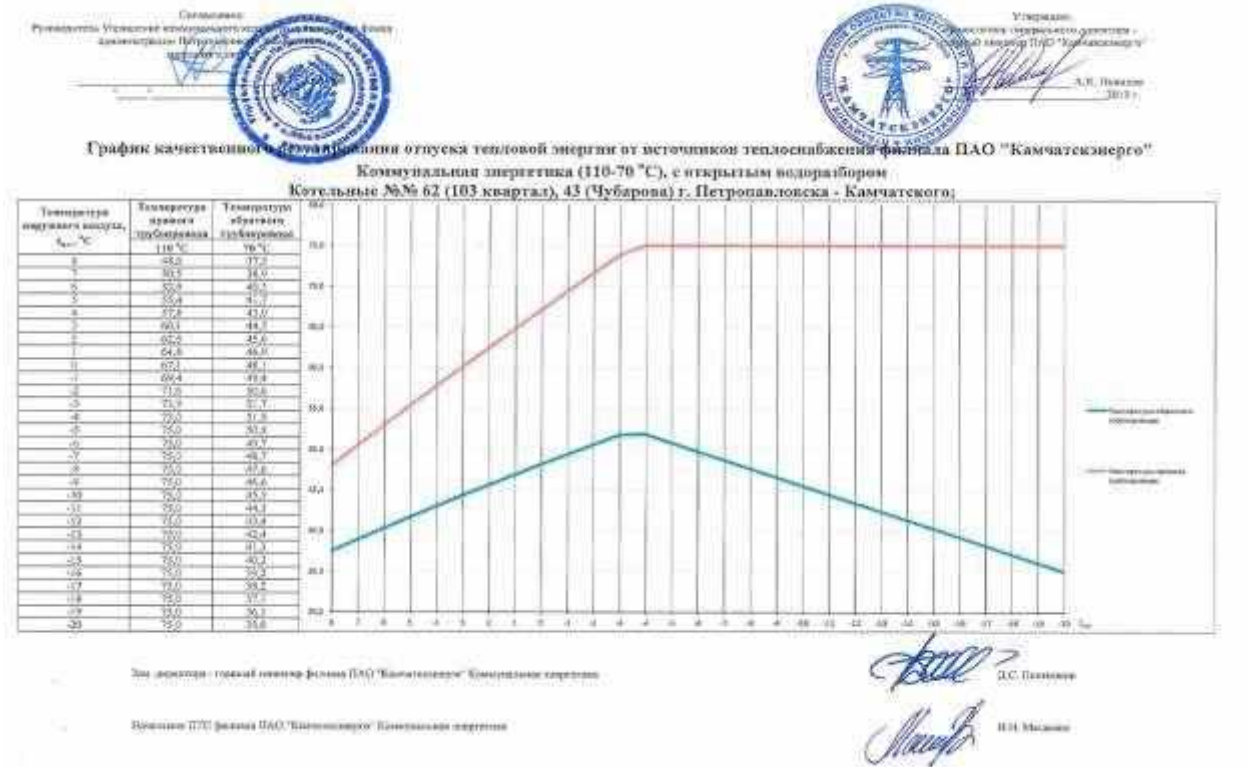
Рисунок 5.8.17 График качественного регулирования отпуска тепловой энергии
