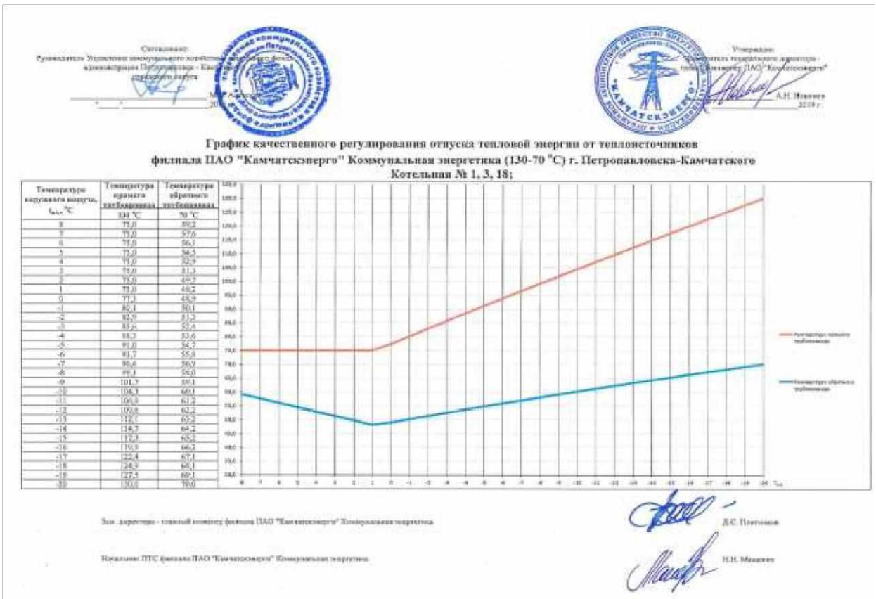
Рисунок 5.8.14 График качественного регулирования отпуска тепловой энергии
