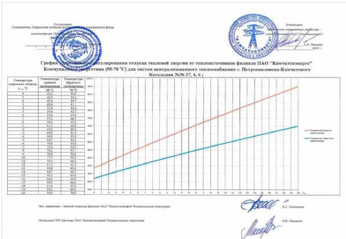
Рисунок 5.8.15 График качественного регулирования отпуска тепловой энергии
