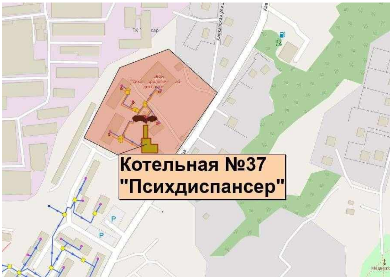
Рисунок 4.1.1-19 Зона действия котельной №37 «Психдиспансер»
