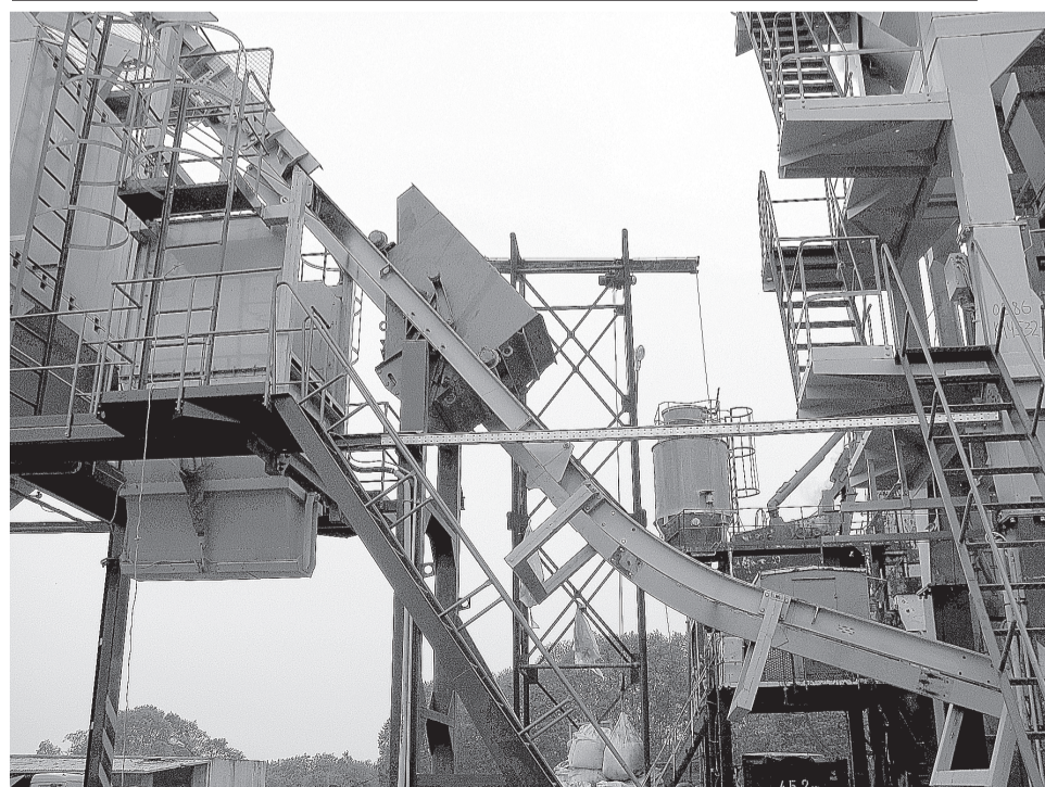
Асфальтосмесительная установка со смесителем периодического действия КДМ 201
