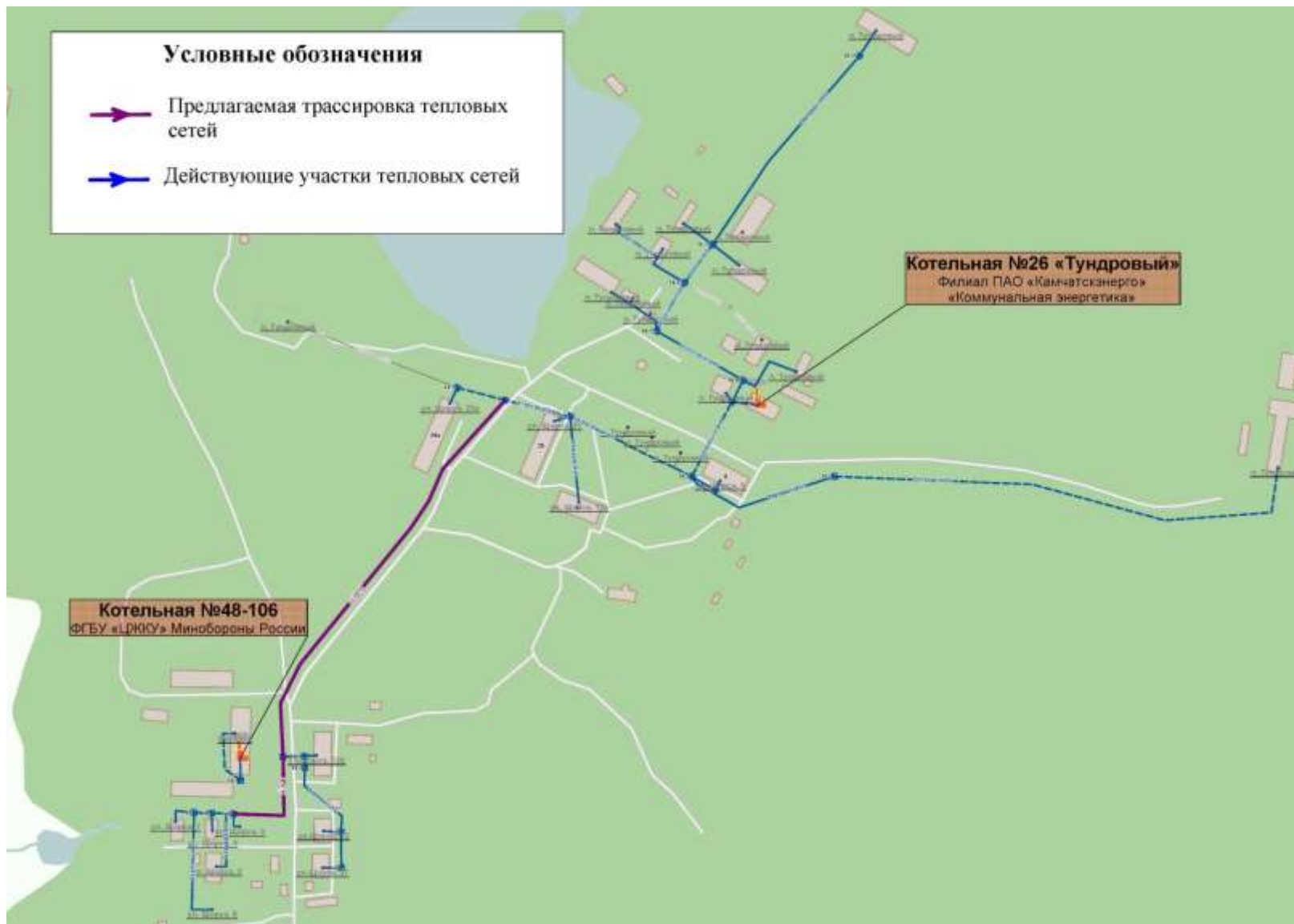
Рисунок 4.13 – Предлагаемый маршрут прокладки тепловых сетей для подключения МКД №№ 2, 3, 5, 7, 8, 12, 126, 27 по ул. Щорса к системе теплоснабжения котельной №26 «Тундровый»
