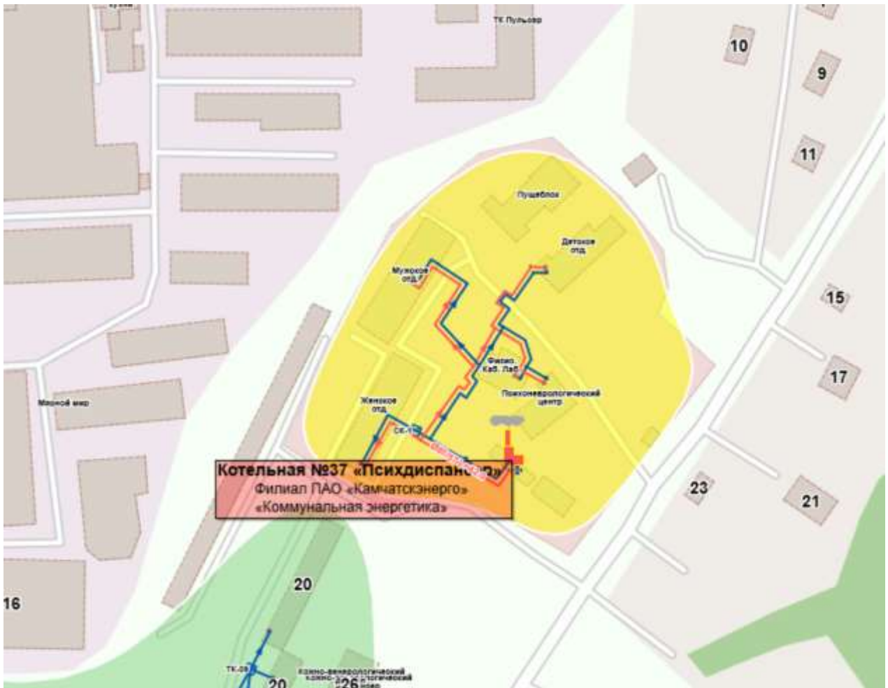
Рисунок 4.18 – Зона действия Котельной №37 «Психдиспансер»
