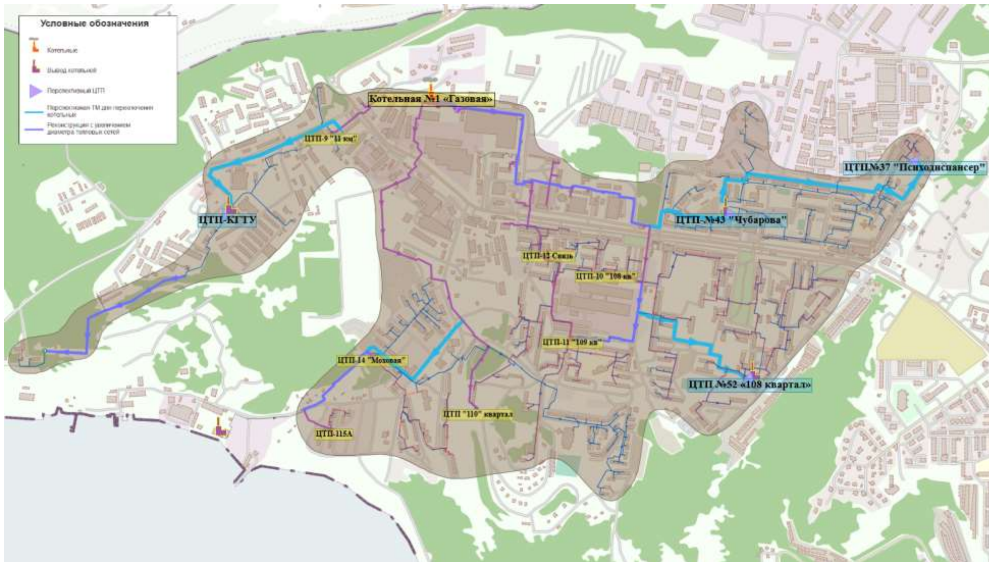
Рисунок 5.2 – Зоны действия источников тепловой энергии по третьему варианту развития системы теплоснабжения котельной №1
