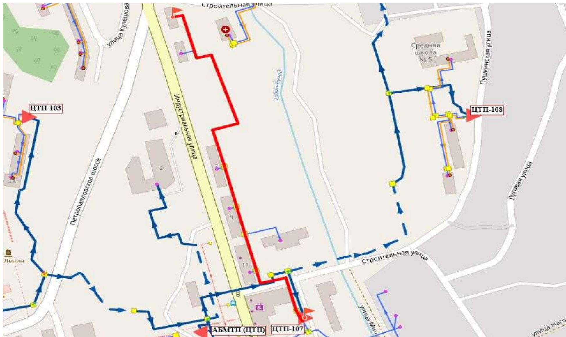
Рисунок 1.1.35. Путь пьезометрического графика от ЦТП 107
