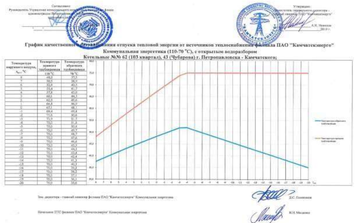
Рисунок 5.8.17 График качественного регулирования отпуска тепловой энергии
