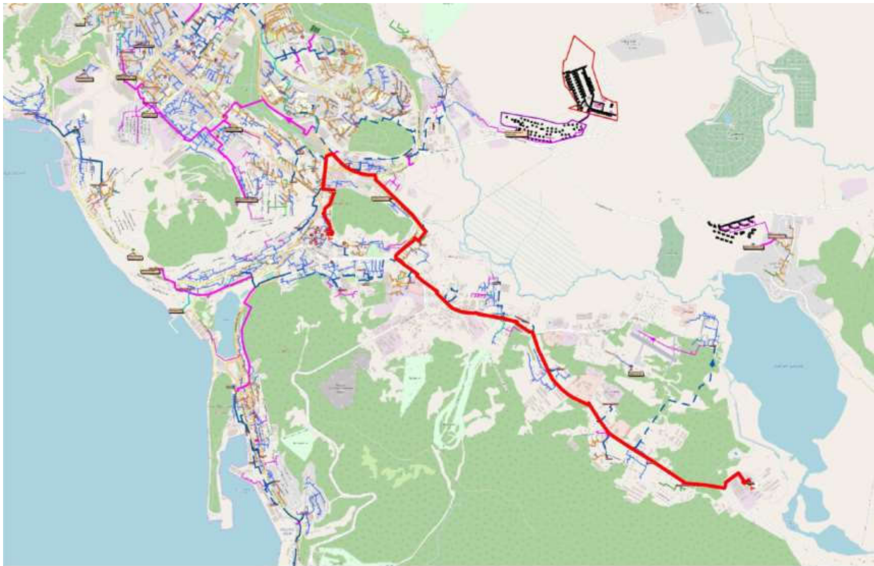
Рисунок 1.1.51. Путь пьезометрического графика от КТЭЦ-2 до ЦТП 324
