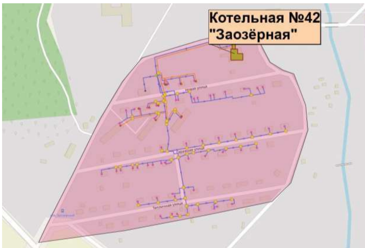
Рисунок 2.1.21. Зона действия котельной №42 «Заозёрная»
