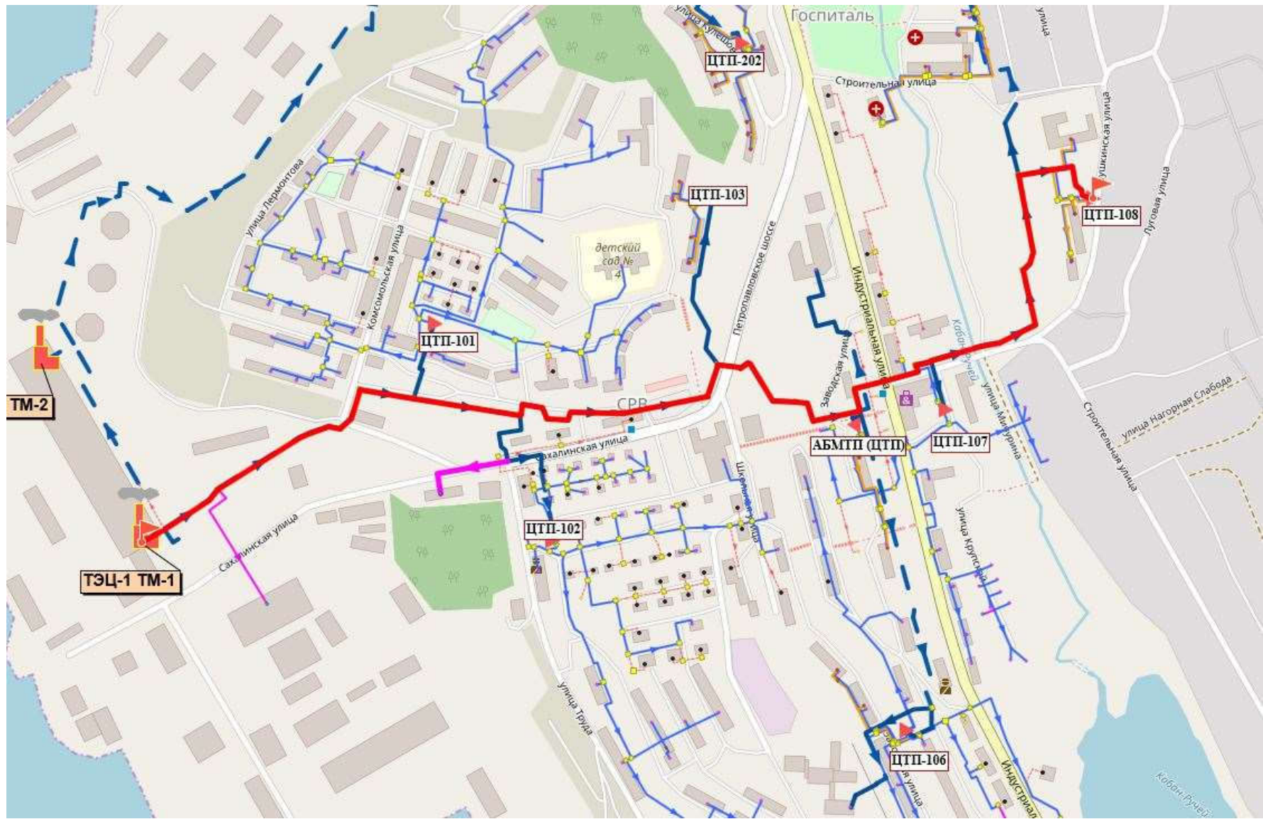
Рисунок 1.1.23. Путь пьезометрического графика от КТЭС 1 до ЦТП 108
