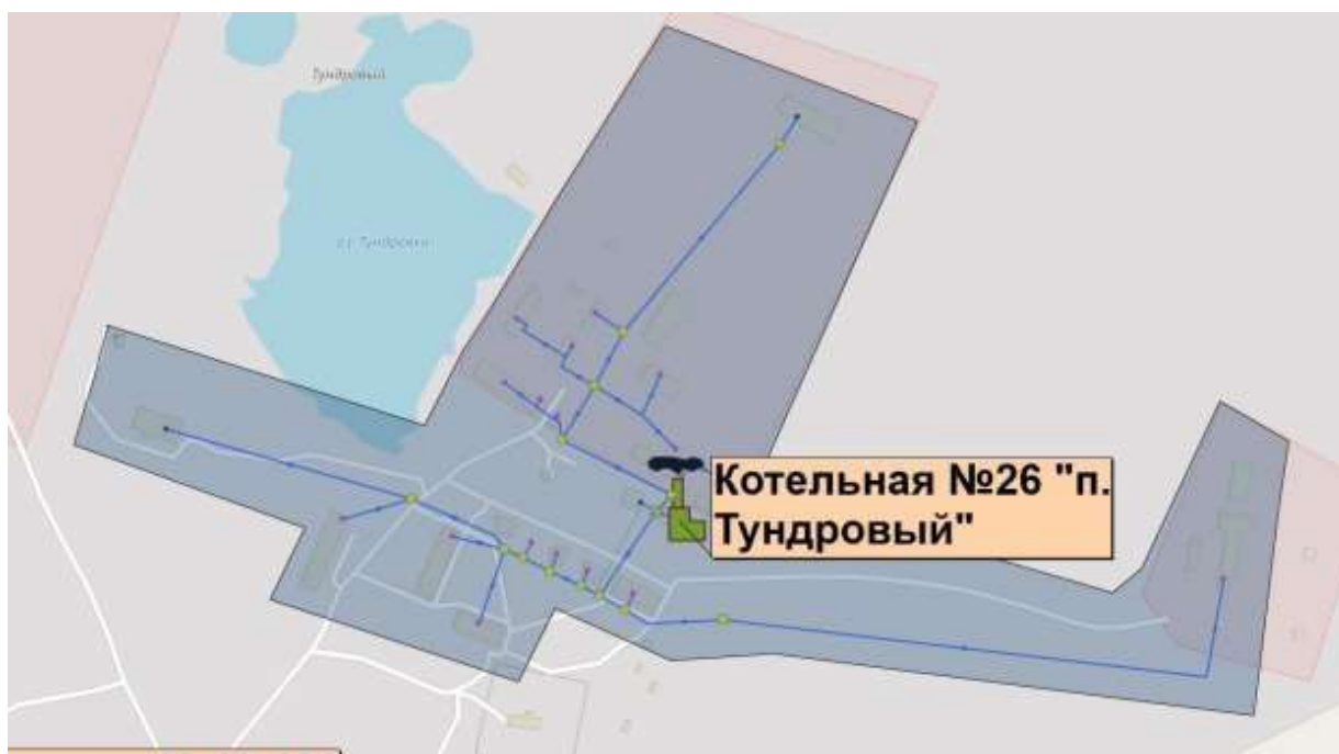
Рисунок 2.1.17. Зона действия котельной №26 «п. Тундровый»
