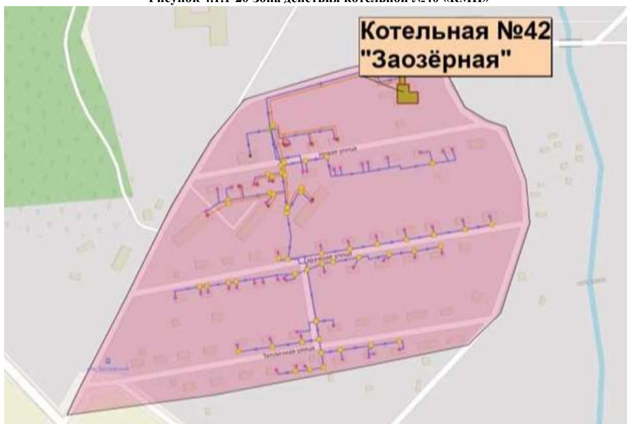
Рисунок 4.1.1-21 Зона действия котельной №42 «Заозёрная»
