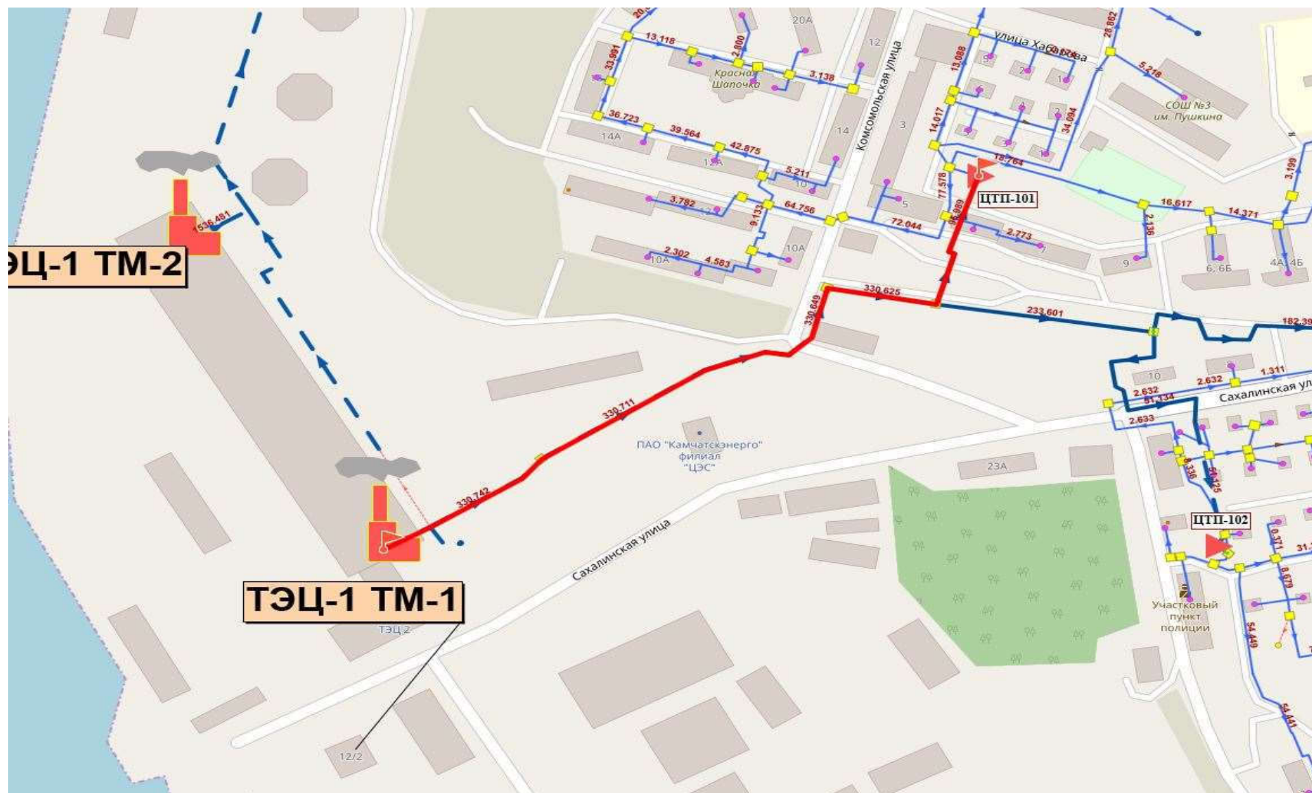
Рисунок 1.1.21. Путь пьезометрического графика от КТЭЦ 1 до ЦТП 101
