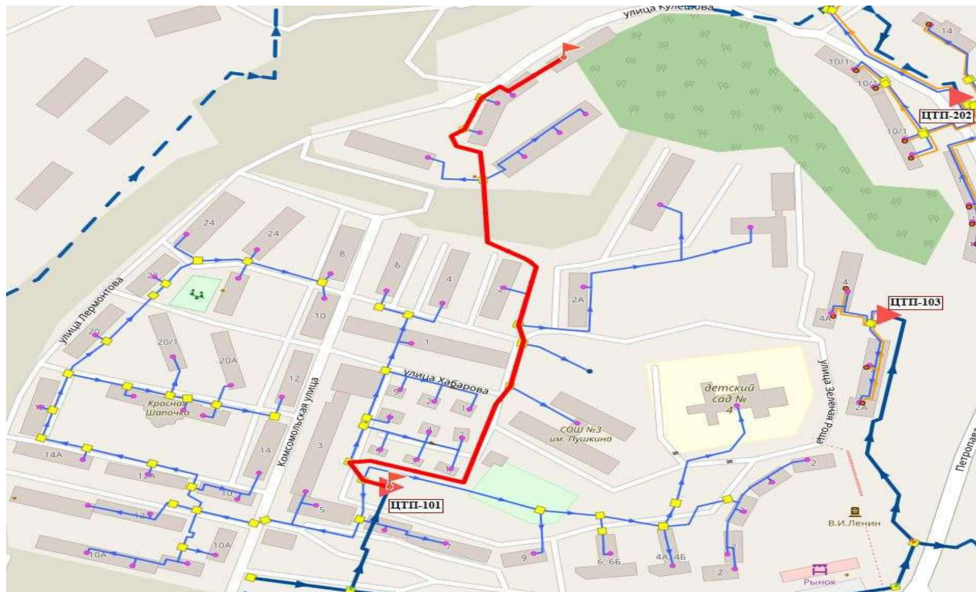
Рисунок 1.1.29. Путь пьезометрического графика от ЦТП 101
