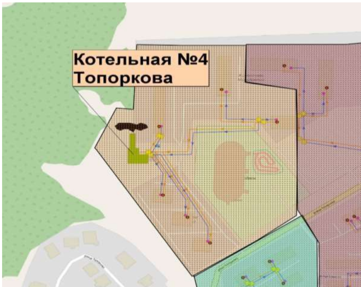
Рисунок 4.1.1-6 Зона действия котельной №4 «Топоркова»
