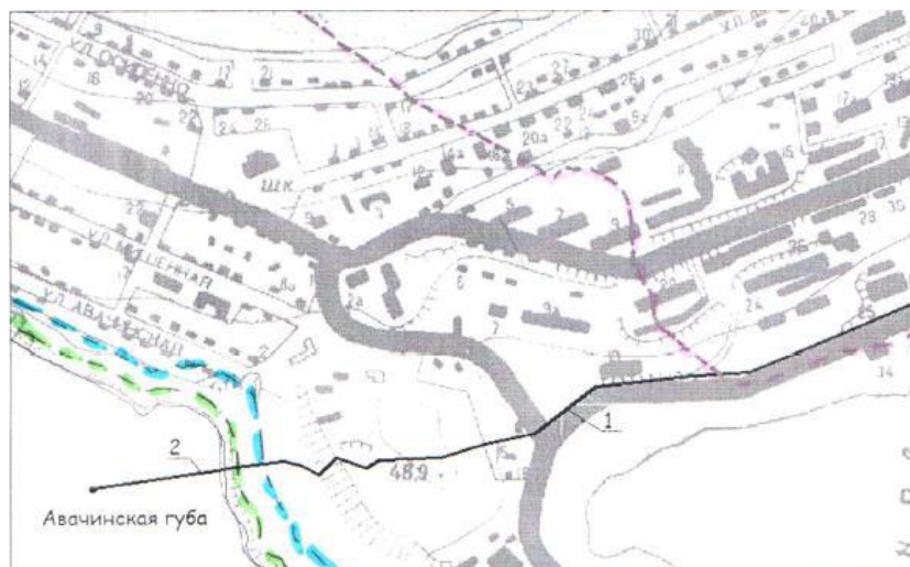
Рисунок 9.27 – План-схема размещения выпуска «Фрунзе», расположенного в Авачинской губе
