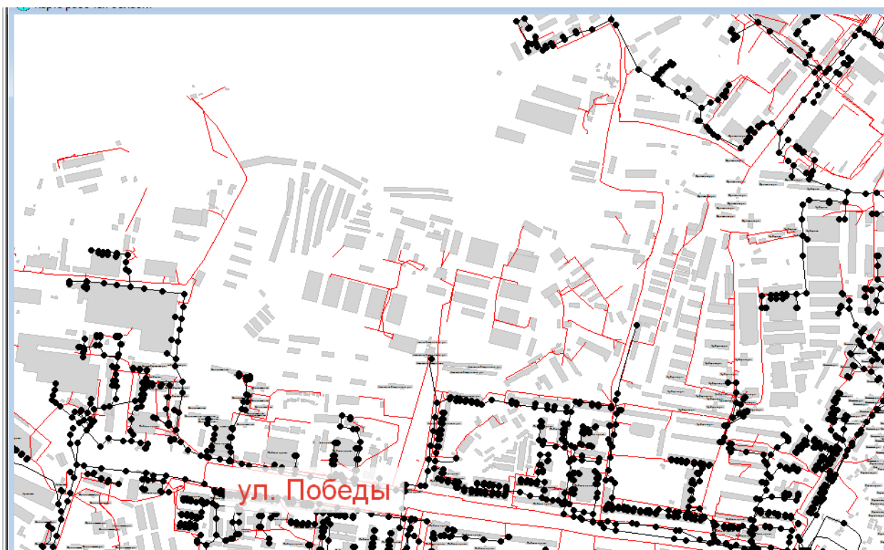
Рисунок 9.49 – Схема территории в районе ул. Победы, не охваченной системой централизованного водоотведения
