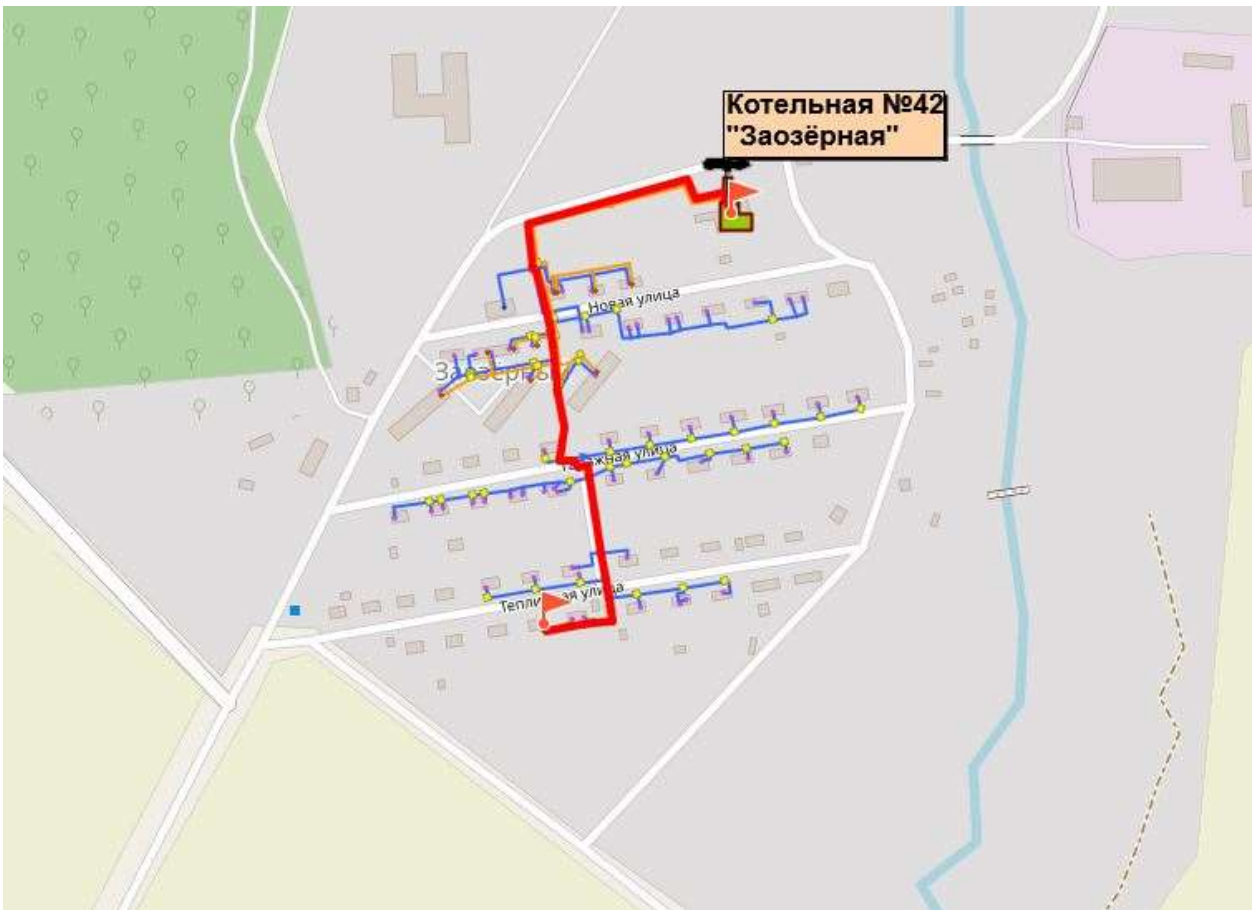
Рисунок 1.1.99. Путь пьезометрического графика от котельной № 42
