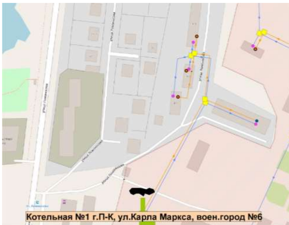
Рисунок 1.3.51. Схемы тепловых сетей от котельной
