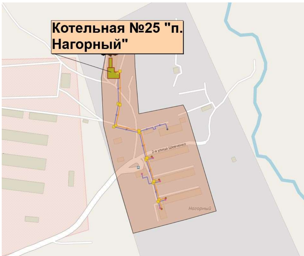
Рисунок 1.4.16. Зона действия котельной №25
