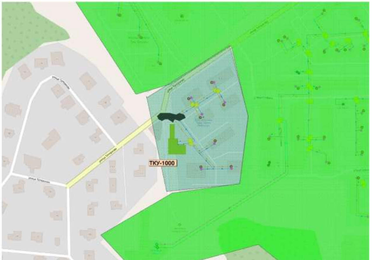
Рисунок 2.1.23. Зона действия котельной ТКУ – 1000
