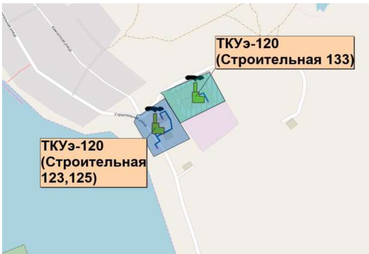
Рисунок 1.4.32. Зона действия электрокотельных
