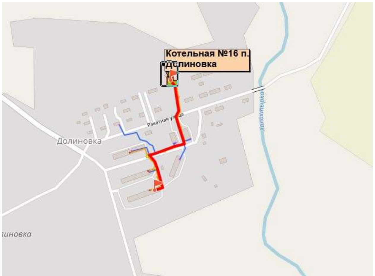
Рисунок 1.1.81. Путь пьезометрического графика от котельной №16
