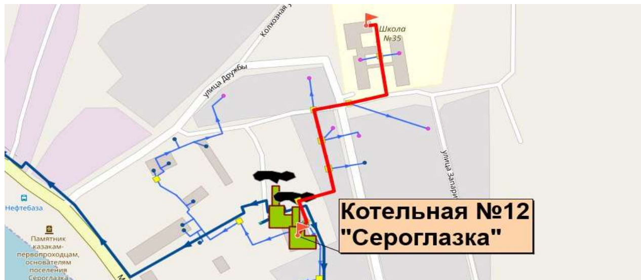
Рисунок 1.1.73. Путь пьезометрического графика от котельной № 12 до школы
