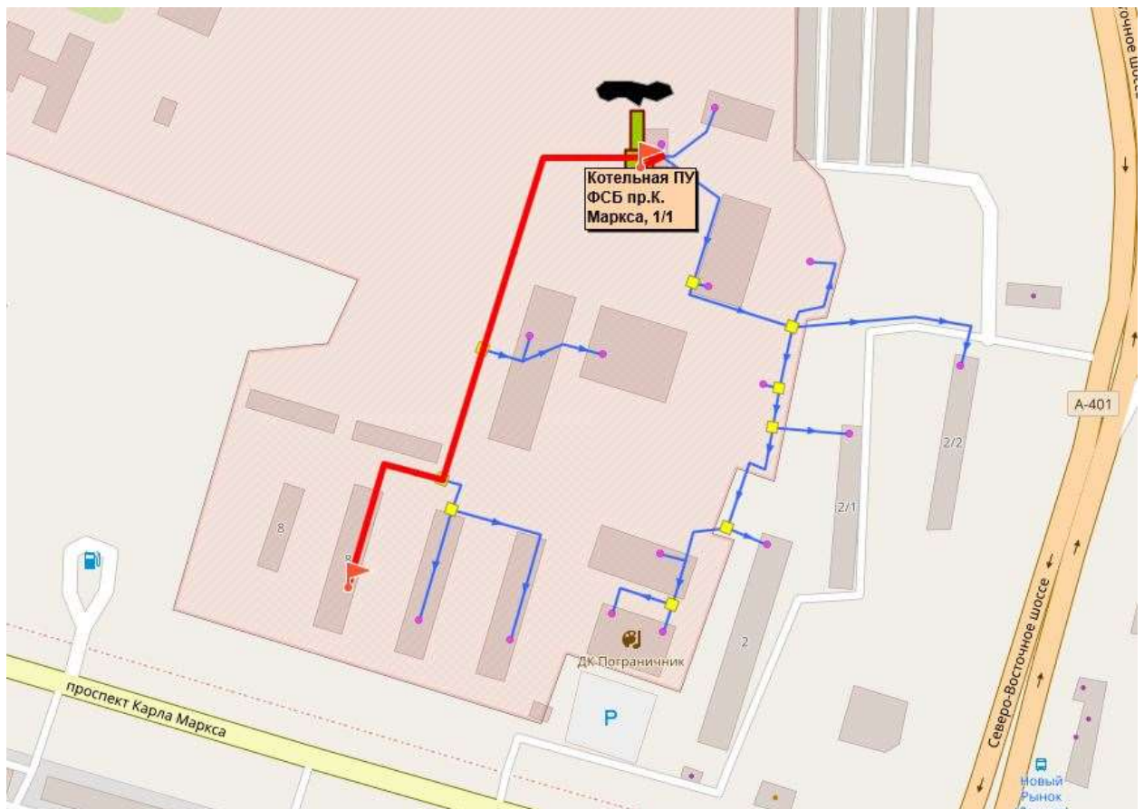
Рисунок 1.1.7. Путь пьезометрического графика от котельной ПУ ФСБ
