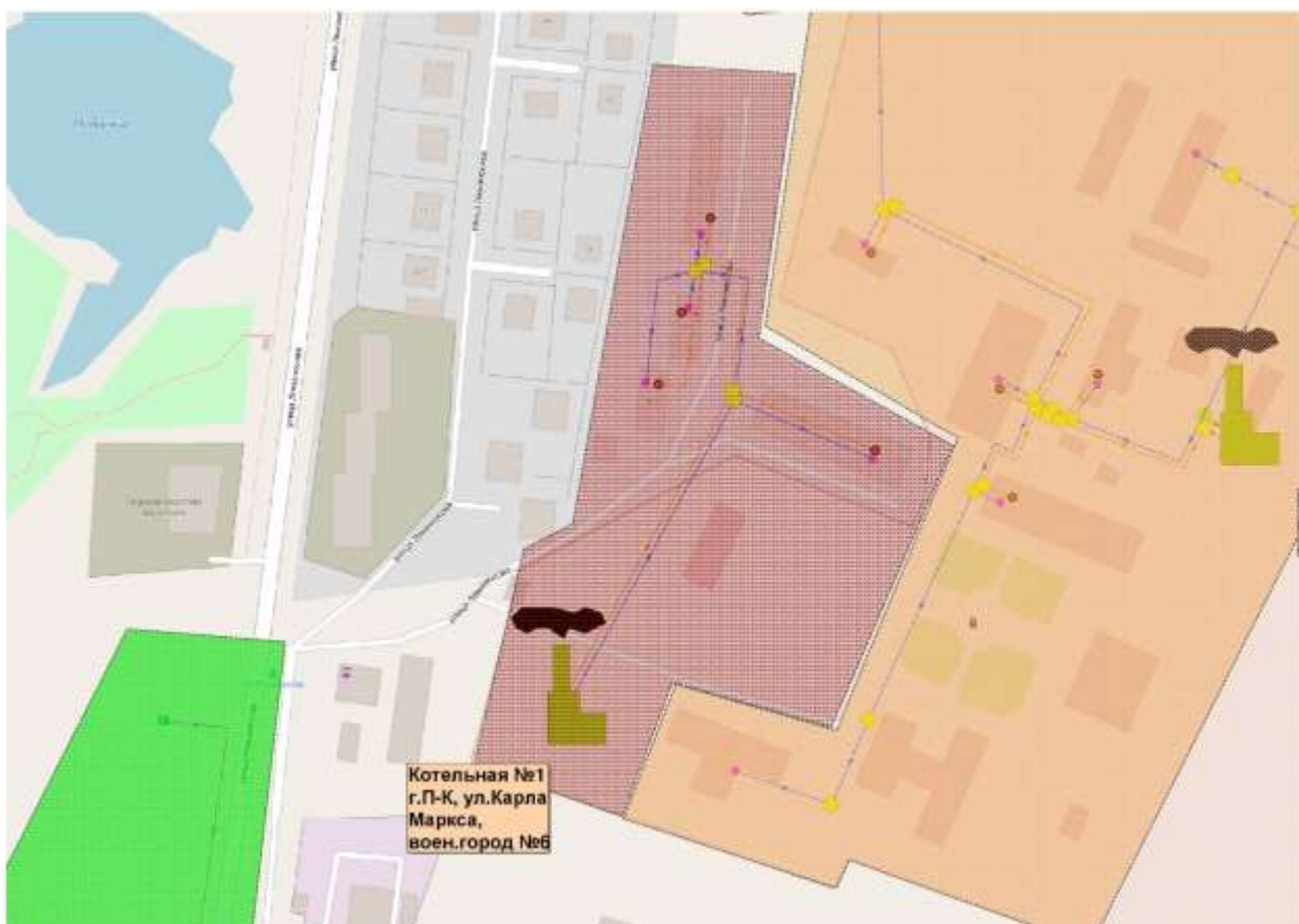
Рисунок 2.1.20. Зона действия котельной «356 УНР»
