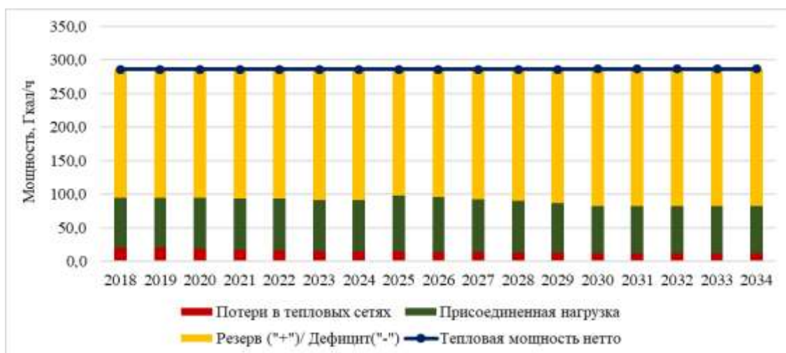
Рисунок 1.4.1. Баланс тепловой мощности КТЭЦ 1
