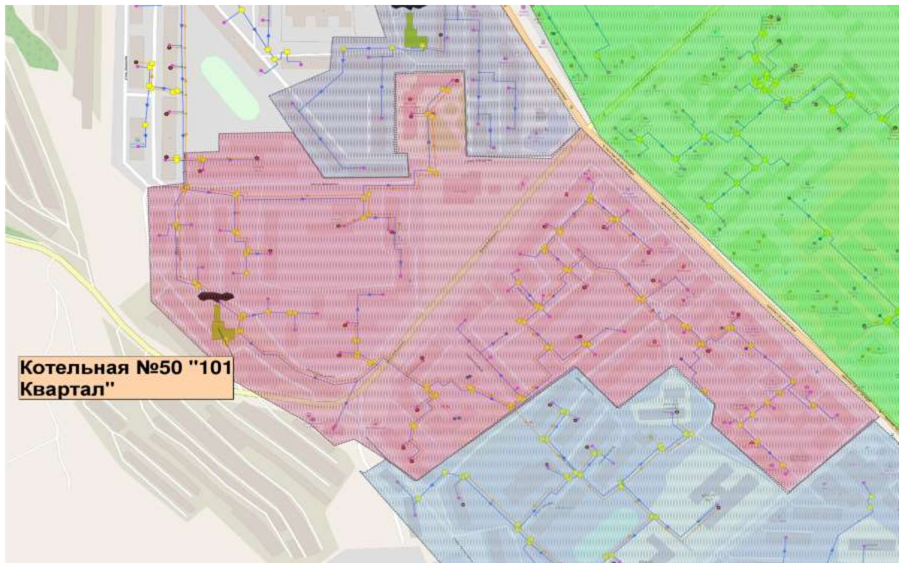
Рисунок 1.4.26. Зона действия котельной №50
